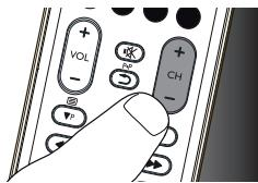
**6** Stiskněte tlačítko
