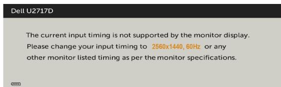
To znamená, že monitor nemôže byť zosynchronizovaný so signálom, ktorý prijíma z počítača. Adresovateľné rozsahy horizontálnej a vertikálnej frekvencie pre tento monitor si pozrite v časti [Technické parametre monitora](#). Odporučaný režim je 2560 x 1440.
