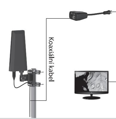
Zapojte signální kabel z antény do konektoru pro vstup signálu na zdroji napájení, zapojte výstupní konektor zdroje napájení do TV, spojte síťový adaptér se zdrojem napájení a připojte do elektrické zásuvky.
