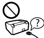
Koristite isključivo kabl za napajanje koji je isporučen uz štampač. Korišćenje drugog kabla može da izazove požar ili strujni udar. Nemojte koristiti kabl sa drugom opremom. Naležiće uživati samo za provod zasiljajućeg dostarcovanog s drukarkom. Upotreba inog provoda može dovesti do požara ili strujnog udara.
