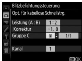
Wenn »**AWL mit optischem Signal**« für »**Blitzbelichtungssteuerung**« > »**Kabellose Blitzsteuerung**« im Fotoaufnahmemenü gewählt ist (☐ 284), wählen Sie einen Kanal für das Master-Blitzgerät. Falls die Slave-Blitzgeräte ein SB-500 einschließen, müssen Sie Kanal 3 einstellen; ansonsten können Sie jeden Kanal von 1 bis 4 wählen.
