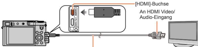
Verwenden Sie ein mit dem HDMI-Logo gekennzeichnetes „Hochgeschwindigkeits-HDMI Mikrokabel“. Kabel, die nicht der HDMI-Norm entsprechen, können nicht verwendet werden. „Hochgeschwindigkeits-HDMI-Mikrokabel“ (Steckverbinder Typ D–Typ A, maximale Länge 2 m)
