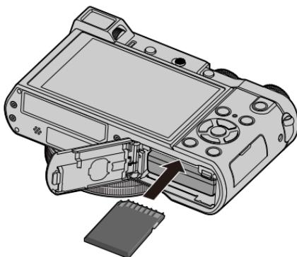
**3** Schließen Sie die Karten-/Akkufachklappe und schieben Sie den Freigabehebel in die Position [LOCK]
