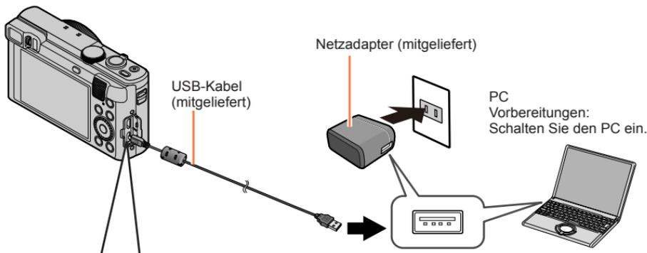
**Zum Aufladen des Akkus schließen Sie das USB-Kabel (mitgeliefert) an die [CHARGE]-Buchse an.**
