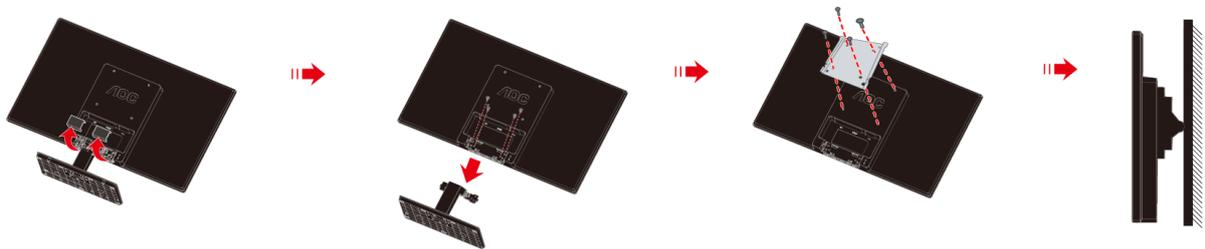
Dieser Monitor kann an einen Wandhängearm, den Sie separat kaufen können, angebracht werden. Trennen Sie bitte vor der Installation die Stromversorgung. Folgen Sie dann den Schritten unten:
