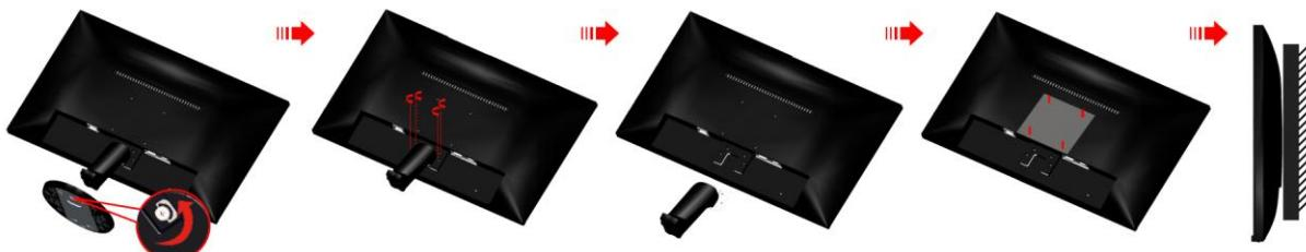
Tento monitor je možné namontovať na stenu prostredníctvom ramena určeného pre montáž na stenu, ktoré si môžete zakúpiť zvlášť. Pred montážou odpojte prívod energie. Postupujte podľa týchto krokov:
