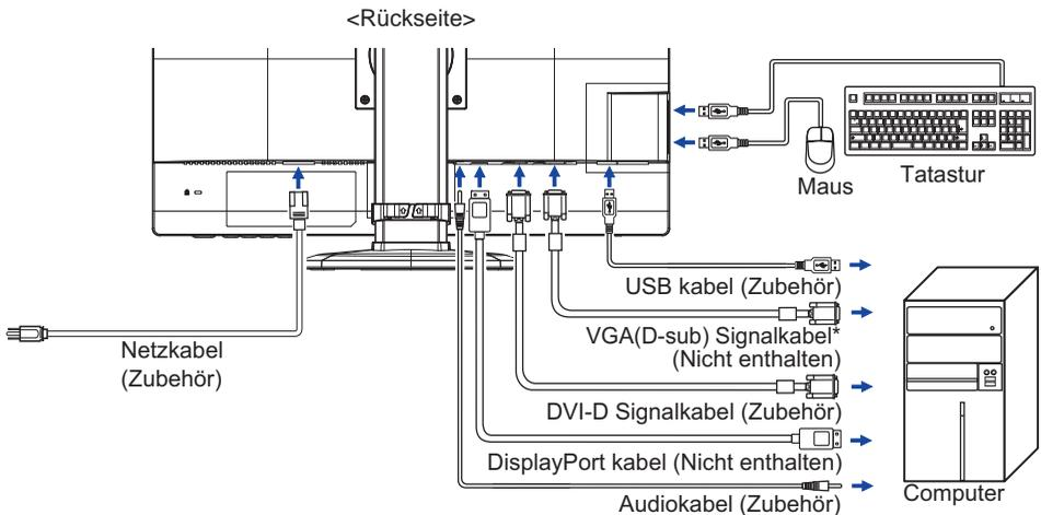
\* Das VGA (D-Sub)-Kabel ist nicht im Lieferumfang enthalten. Für den Betrieb über VGA benötigen Sie ein spezielles VGA (D-Sub-Kabel) für dieses Modell. Bitte kontaktieren Sie das iiyama Support Center in Ihrem Land, wenn Sie den Monitor über den VGA-Eingang anschließen wollen.
