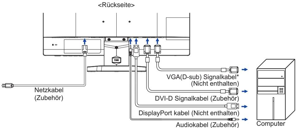
\* Das VGA (D-Sub)-Kabel ist nicht im Lieferumfang enthalten. Für den Betrieb über VGA benötigen Sie ein spezielles VGA (D-Sub-Kabel) für dieses Modell. Bitte kontaktieren Sie das iiyama Support Center in Ihrem Land, wenn Sie den Monitor über den VGA-Eingang anschließen wollen.
