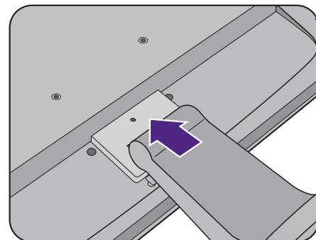
Versuchen Sie vorsichtig, die beiden Teile wieder auseinander zu ziehen, um zu überprüfen, ob sie korrekt zusammengefügt wurden.
