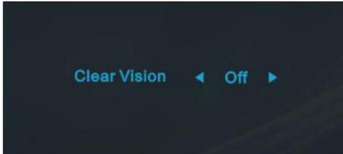
3. Halten Sie die Taste „<“ zur Aktivierung der Clear Vision-Demo 5 Sekunden gedrückt, die Meldung „Clear Vision-Demo: Ein“ wird 5 Sekunden auf dem Bildschirm angezeigt; drücken Sie zum Ausblenden der Anzeige die Menü- oder Verlassen-Taste. Halten Sie die Taste „<“ zum Ausschalten der Clear Vision-Demo noch einmal 5 Sekunden gedrückt.
