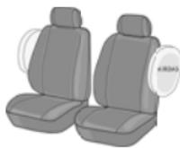
b) Nakkestøtteåpninger, ryggstøttets justeringsspak/-hjul til løsning av ryggstøtte og armlener må ikke dekkes til av setetrekket. Det må lages passende åpninger. Legg i den anledning merke til monteringsveiledningen på den forrige siden.
