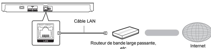
Utilisez des câbles LAN droits de catégorie 5 ou supérieure (STP) pour connecter les appareils périphériques.
