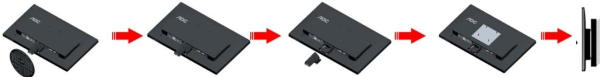
Dieser Monitor kann an einen Wandhängearm, den Sie separat kaufen können, angebracht werden. Trennen Sie bitte vor der Installation die Stromversorgung. Folgen Sie dann den Schritten unten:
