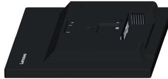
Schritt 4: Bringen Sie die Halterung aus dem VESA-Wandmontageset (100 × 100 mm Lochabstand) mit M4 x 10 mm-VESA-Montageschrauben an.
