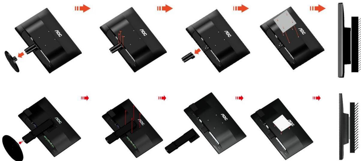
Tento monitor je možné namontovať na stenu prostredníctvom ramena určeného pre montáž na stenu, ktoré si môžete zakúpiť zvlášť. Pred montážou odpojte prívod energie. Postupujte podľa týchto krokov:
