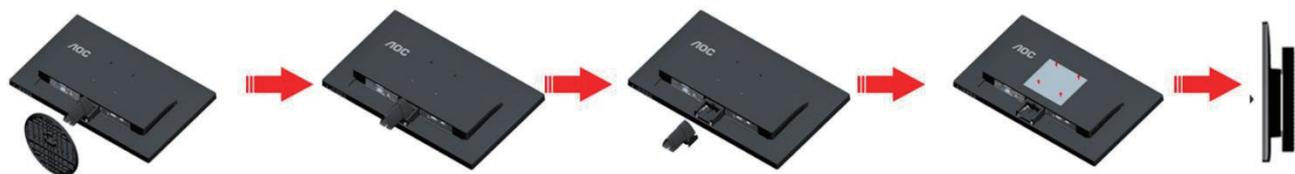
Tento monitor je možné namontovať na stenu prostredníctvom ramena určeného pre montáž na stenu, ktoré si môžete zakúpiť zvlášť. Pred montážou odpojte prívod energie. Postupujte podľa týchto krokov:
