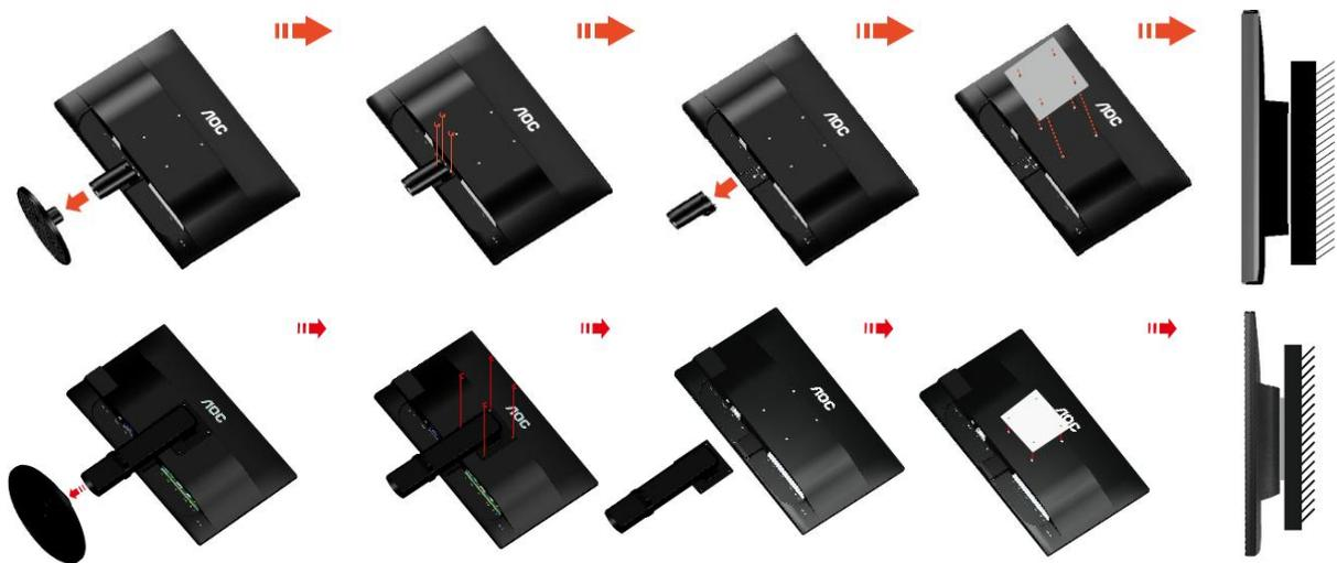
Dieser Monitor kann an einen Wandhängearm, den Sie separat kaufen können, angebracht werden. Trennen Sie bitte vor der Installation die Stromversorgung. Folgen Sie dann den Schritten unten:
