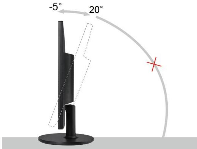
2> Der Monitor kann um  $-5^\circ$  bis  $20^\circ$  geschwenkt werden.
