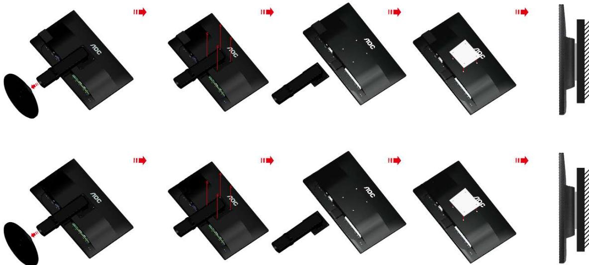
Tento monitor lze připevnit na závěsné rameno, které lze zakoupit samostatně. Než budete pokračovat v montáži, odpojte napájení. Postupujte následujícím způsobem:
