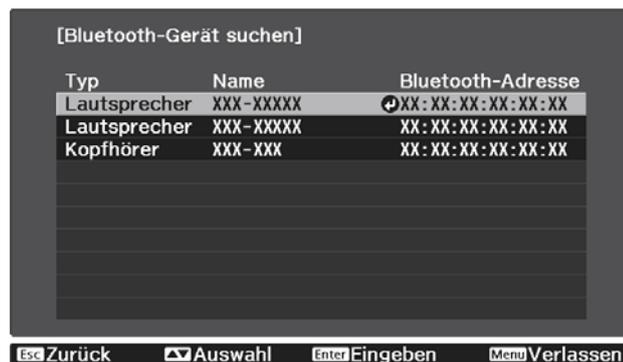
Wenn Sie den Projektor das nächste Mal einschalten, verbindet er sich automatisch mit dem zuletzt verbundenen Gerät.
