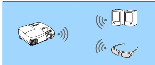
Per HDMI1-Anschluss, HDMI2-Anschluss, Audio (L-R)-Anschluss oder Screen Mirroring eingehender Ton wird über Lautsprecher oder Kopfhörer mit Bluetooth-Unterstützung ausgegeben.
