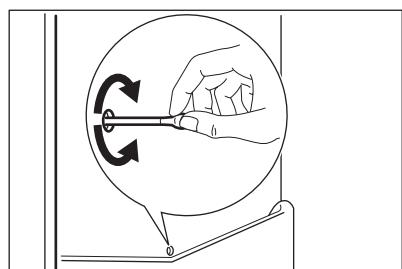
Med običajno uporabo se ob vsaki zaustavitvi kompresorja ivje samodejno odtaja z izparilniku v hladilnem prostoru. Odtajana voda odteka skozi odprtino za odtekanje vode v posebno posodo na zadnji strani naprave nad kompresorjem, kjer izhlapi.
