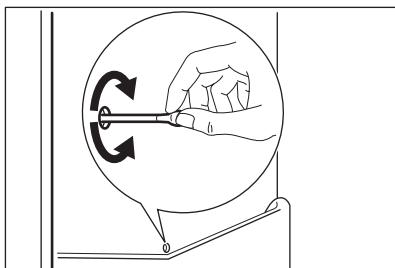
Pri normálnom používaní sa námraza automaticky odstraňuje z výparníka chladiaceho priestoru pri každom zastavení motoru kompresora. Odmrazená voda odteká cez žliabok do osobitnej nádoby na zadnej stene spotrebiča nad motorom kompresora, z ktorej sa odparuje.
