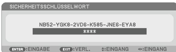
**HINWEIS:** Der Sicherheits-Deaktivierungsmodus wird beibehalten bis die Stromversorgung ausgeschaltet oder das Netzkabel abgetrennt wird.
