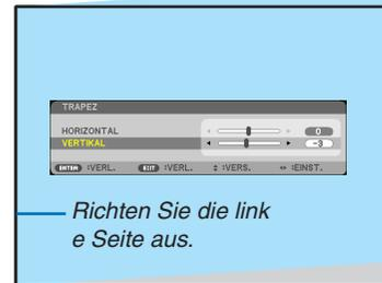
**4. Drücken Sie die ▲ -Taste, um [HORIZONTAL] auszuwählen, und verwenden Sie anschließend ◀ oder ▶, so dass die obere und untere Seite des projizierten Bildes parallel sind.**
