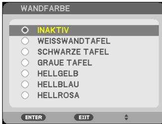
Diese Funktion ermöglicht eine schnelle, anpassungsfähige Farbkorrektur bei Verwendung eines Bildschirmmaterials, dessen Farbe nicht Weiß ist.
