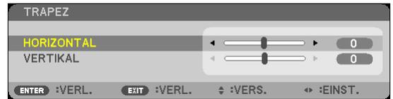
**2. Drücken Sie die ▼ -Taste, um [VERTIKAL] auszuwählen, und verwenden Sie anschließend ◀ oder ▶, so dass die linke und rechte Seite des projizierten Bildes parallel sind.**
