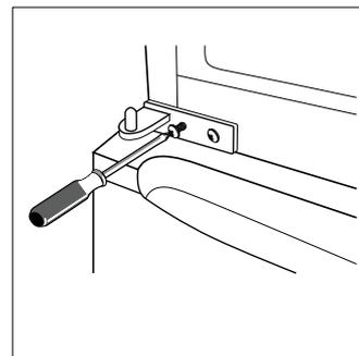
9. Nasadíte horné dvere späť. Než definitívne zaskrutkujete horný záves, skontrolujte, či dvere horizontálne aj vertikálne doliehajú a či tesnenie po všetkých stranách správne dosadá. Potom priložte záves a zaskrutkujte ho do hornej časti spotrebiča.
