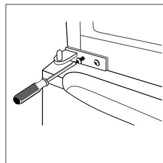
9. Nasadíte horní dveře zpět. Než definitivně zašroubujete horní závěs, zkontrolujte, zda dveře horizontálně i vertikálně lícují a zda těsnění po všech stranách správně dosedá. Poté přiložte závěs a zašroubujte jej do horní části spotřebiče.
