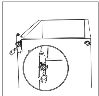
11. Vráťte dvere späť. Než definitívne dotiahnete skrutky, skontrolujte, či dvere horizontálne aj vertikálne doliehajú a či tesnenie po všetkých stranách správne dosadá.
