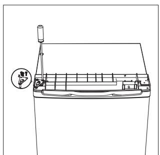
12. Nasadťte horný kryt a upevnite ho pomocou 2 skrutiek na zadnej strane.
