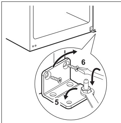
9. Scoateți șuruburile balamalei inferioare și îndepărtați balamaua (8).
