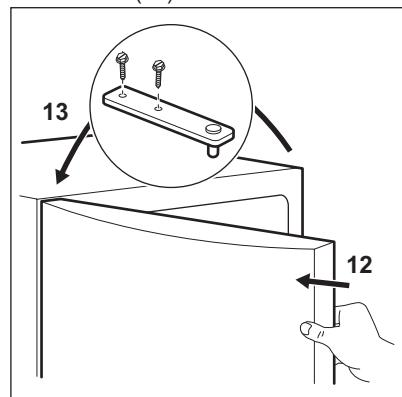
17. Prindeți mânerele ușii și căpăcelele pe partea opusă.
