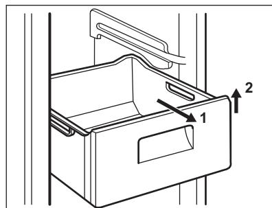
Când o punete înapoi, ridicați puțin partea din față a cutiei pentru a o introduce în congelator. După ce au trecut peste opritoare, împingeți cutiile înapoi pe poziția lor.
