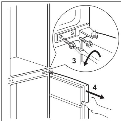
8. Odskrutkujte čap dolného závesu (5) a zaskrutkujte čap dolného závesu (6) do ľavého otvoru dolného závesu.
