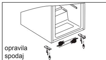
Odvijte zgornji zatič in privijte ga na drugo stran. Nataknite vrata na zgornji zatič in zaprite jih. Privijte nosilec zatiča na mesto na drugo stran.
