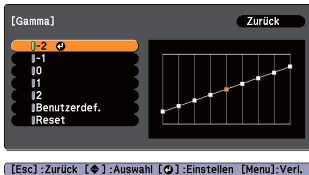
Wenn ein kleinerer Wert ausgewählt wird, werden die dunklen Bereiche der Bilder heller, aber die Farbsättigung der helleren Bereiche kann jedoch schwächer werden. Wenn ein größerer Wert ausgewählt wird, können Sie die Gesamthelligkeit des Bildes reduzieren und das Bild schärfer machen.
