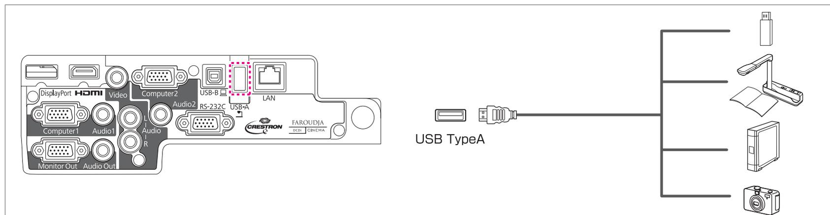
Bei angeschlossenem USB-Gerät, wie einem USB-Speichermedium oder einer Digitalkamera, können Sie dessen Dateien als Dia-Show projizieren.
