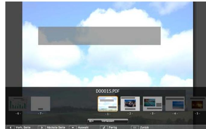
Wählen Sie die zu projizierende Seite mithilfe der Taste [⏪] oder [⏩] und drücken Sie dann die [↵]-Taste, um die gewählte Seite anzuzeigen. Wenn Sie die [Esc]-Taste drücken, während das Menü Seite wählen angezeigt wird, wird das Menü geschlossen.
