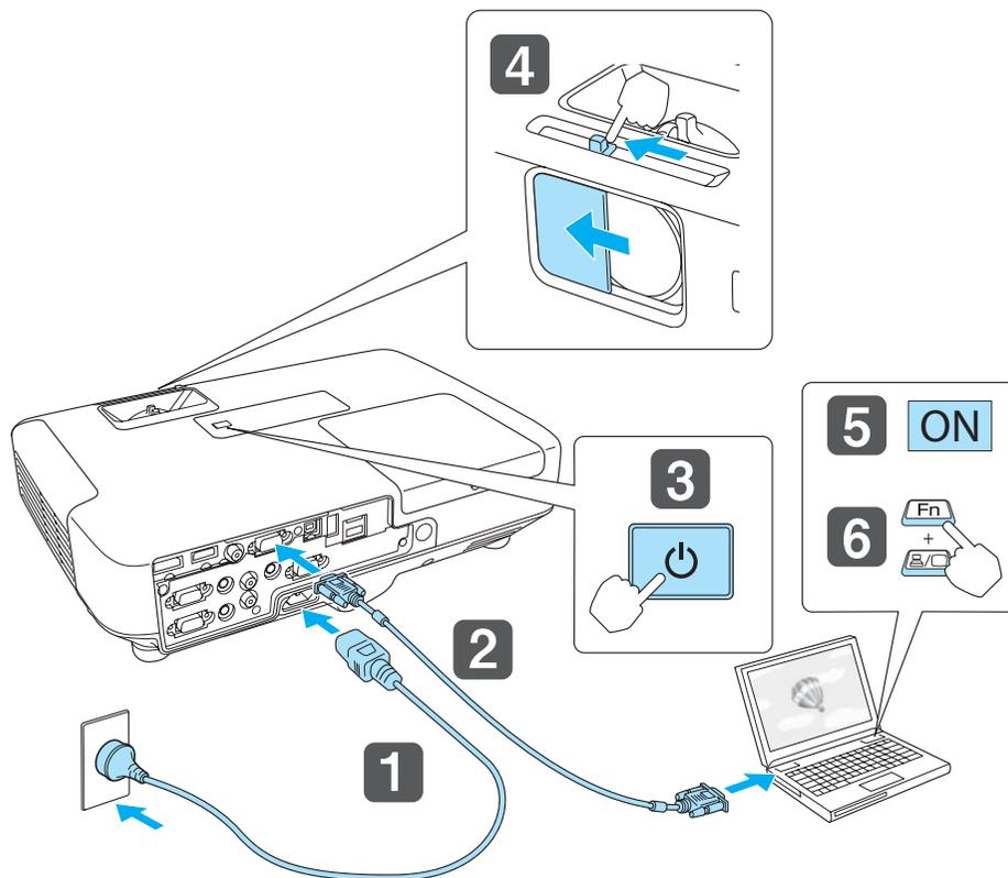
**1** Schließen Sie den Projektor mit dem Netzkabel an eine Steckdose an.
