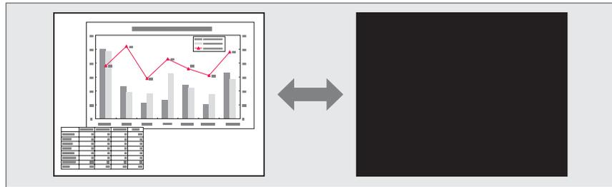
Mit jeder Betätigung der Taste [A/V Mute] bzw. bei jedem Öffnen/Schließen des Objektivdeckels wird A/V Mute ein- oder ausgeschaltet.
