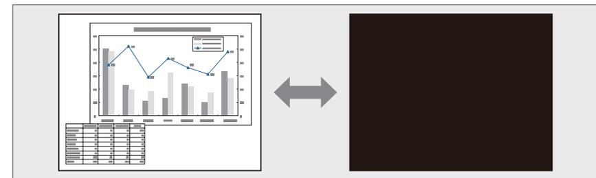
Bei jedem Drücken der [A/V Mute]-Taste wird A/V Stummschalten ein- bzw. ausgeschaltet.
