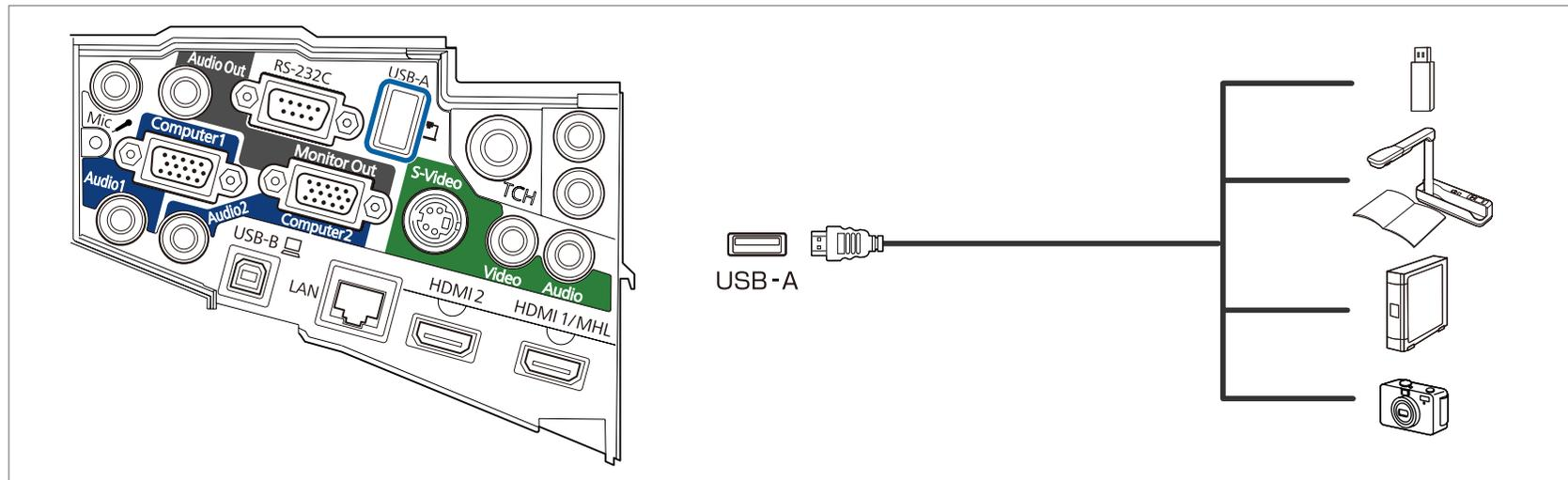
Mit angeschlossenem USB-Gerät können Sie Bilddateien von einem USB-Speichermedium oder einer Digitalkamera als PC Free projizieren.
