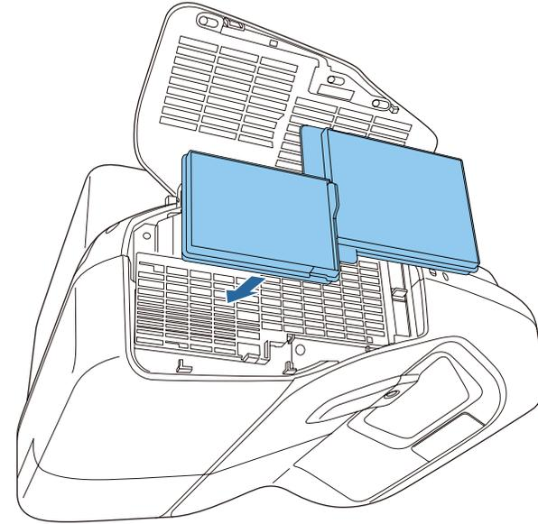
**5** Schließen Sie die Abdeckung des Luftfilters.
