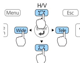
Sie können das Bild diagonal verschieben, indem Sie ein beliebiges Paar der benachbarten Tasten [↖], [↗], [↘] und [↙] oder eine Kombination aus den Tasten [↖], [↗], [Wide] und [Tele] an der Fernbedienung oder am Bedienfeld drücken.
