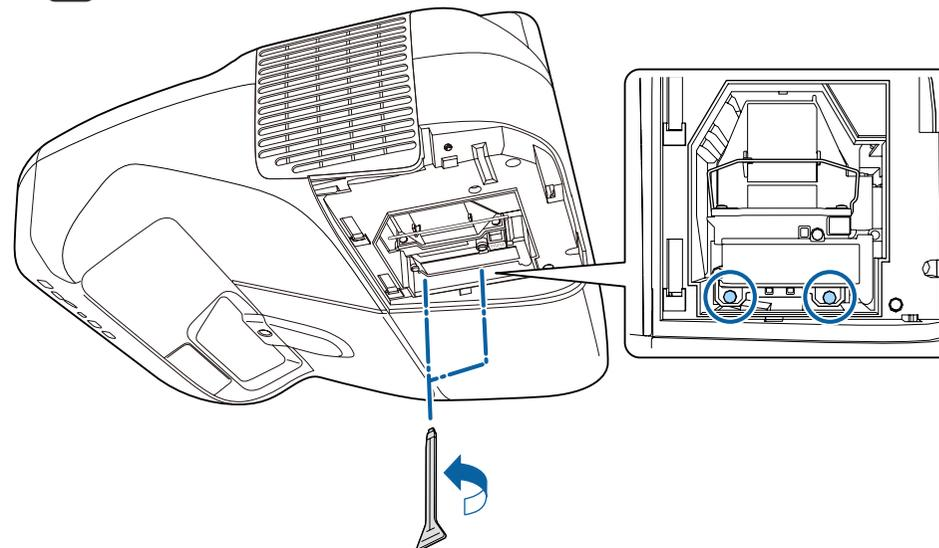
**4** Entfernen Sie die alte Lampe, indem Sie am Griff ziehen. Wenn die Lampe beschädigt ist: Ersetzen Sie die Lampe durch eine neue oder wenden Sie sich an Ihren Händler.
