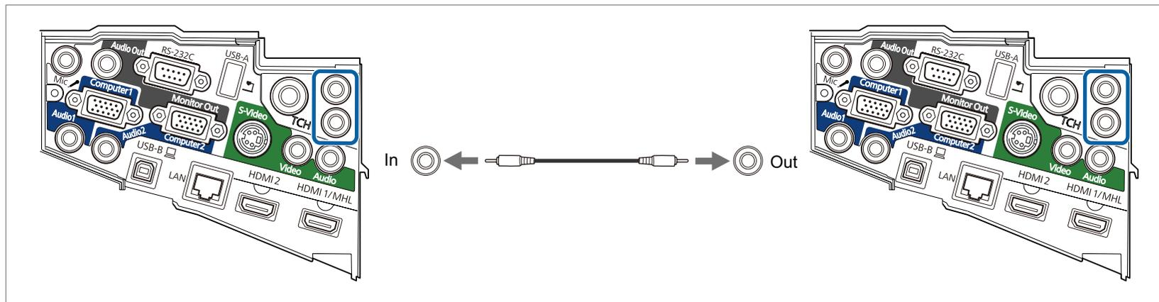
Der SYNC-Port hat einen Eingang und einen Ausgang. Wenn Sie ein Ende des Fernbedienungs-Kabelsets an einem Eingang anschließen, verbinden Sie das andere Ende mit einem Ausgang.
