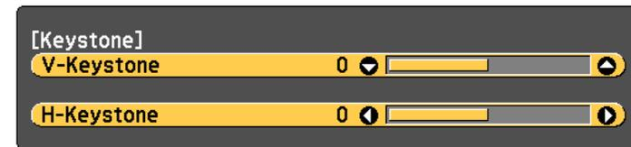
Wenn Sie die Tasten [↖][↗] am Bedienfeld drücken, wird das im Konfiguration-Menü eingestellte Korrekturmethodenfenster angezeigt. Wenn Sie eine horizontale und vertikale Trapezkorrektur über die Tasten [↖][↗] ausführen möchten, stellen Sie **Keystone** im Konfiguration-Menü auf **H/V-Keystone** ein.
