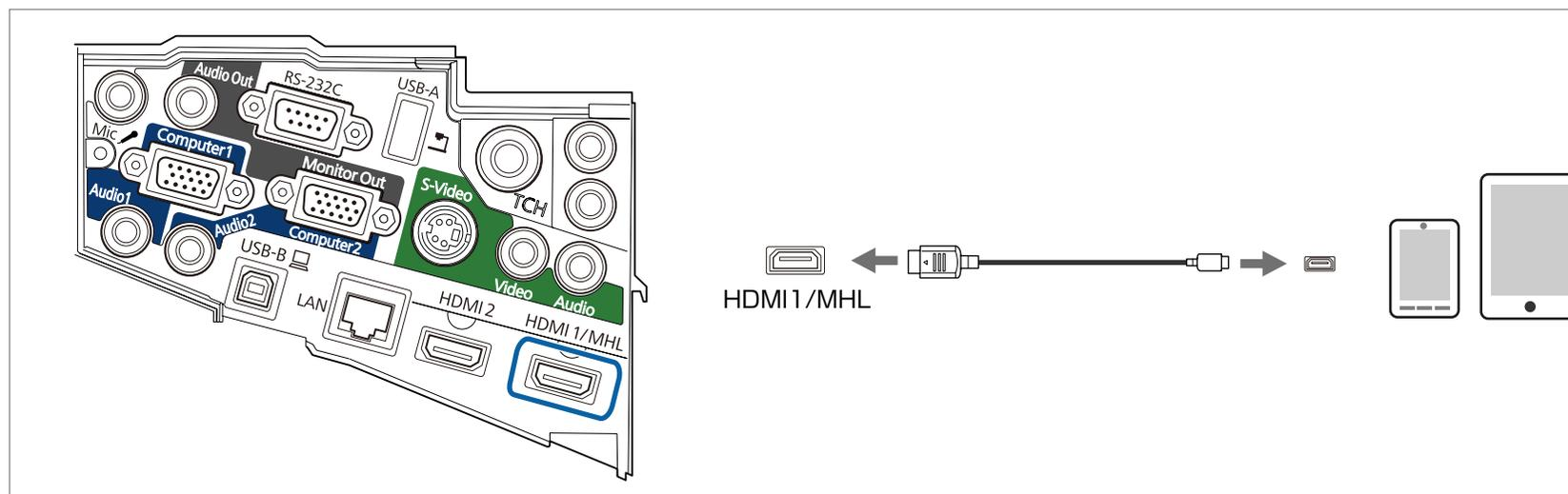
Wenn Sie ein Smartphone oder Tablet-Gerät mit dem Projektor verbinden, beginnt das Gerät mit dem Aufladen, während Bilder projiziert werden.
