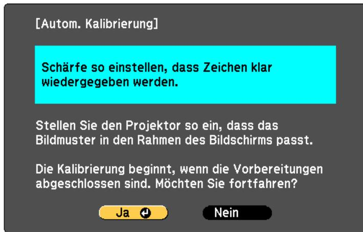
**4** Passen Sie den Fokus bei Bedarf an, indem Sie die Luftfilterabdeckung an der Seite des Projektors öffnen und den Fokushebel verschieben.
