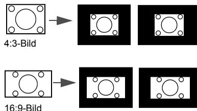
3. **4:3:** Skaliert ein Bild so, dass es in der Mitte der Leinwand in einem Bildformat von 4:3 projiziert wird. Diese Einstellung eignet sich besonders für Bilder im 4:3-Bildformat, beispielsweise für Computermonitore, herkömmliche Fernsehbilder und 4:3-DVD-Filme, da sich bei solchen Bildern keine Änderung des Bildformates ergibt.
