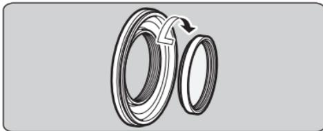
**Anbringen des 30,5 mm Filters am Objektiv DA 40 mm f/2,8 Limited**
