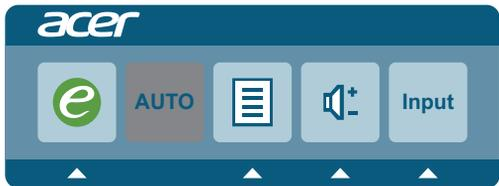
Drücken Sie zum Öffnen des Schnellmenüs eine der Funktionstasten (Empowering-Taste, **Auto**-Taste oder **Menü**-Taste). Über das Schnellmenü können Sie die gebräuchlichsten Einstellungen sehr schnell auswählen.
