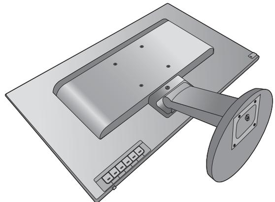
Lösen Sie die Schraube, die den Ständer am Monitor befestigt. Wir empfehlen die Verwendung eines Schlitzschraubendrehers. Ziehen Sie dann den Monitorständer nach hinten vom Monitor weg.
