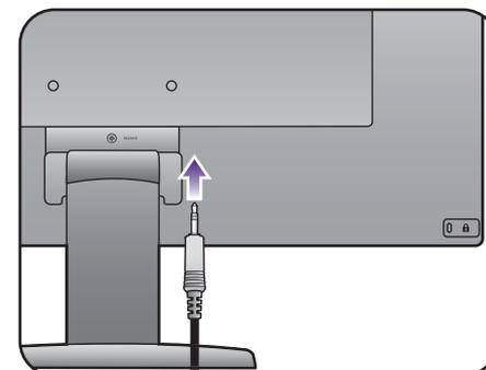
Sie können Kopfhörer an die Kopfhörerbuchse neben dem Line-In-Anschluss des Monitors anschließen.
