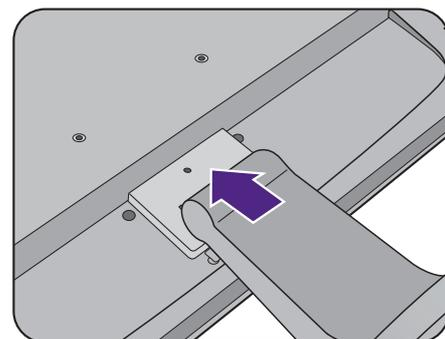
Versuchen Sie vorsichtig, die beiden Teile wieder auseinander zu ziehen, um zu überprüfen, ob sie korrekt zusammengefügt wurden.
