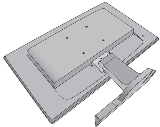
Entfernen Sie den Monitorsockel wie unter "[So trennen Sie den Monitorsockel ab](#)" auf Seite 14 beschrieben wird.
