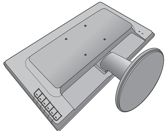
Fügen Sie einen spitzen Gegenstand wie z.B. einen Schraubenzieher in die Öffnung über dem Monitorständerarm ein und drücken Sie den Schraubenzieher anschließend gegen die Auslösetaste im Inneren der Öffnung. Ziehen Sie dann den Monitorständer nach hinten vom Monitor weg.
