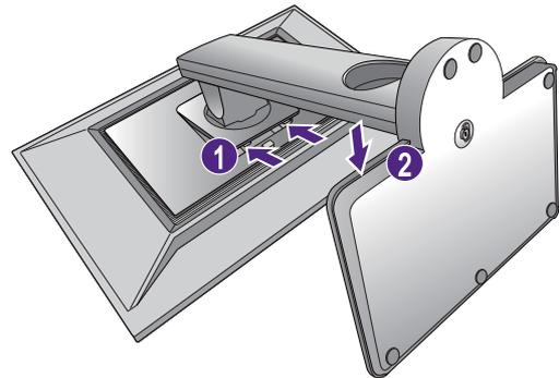
Versuchen Sie vorsichtig, die beiden Teile wieder auseinander zu ziehen, um zu überprüfen, ob sie korrekt zusammengefügt wurden.
