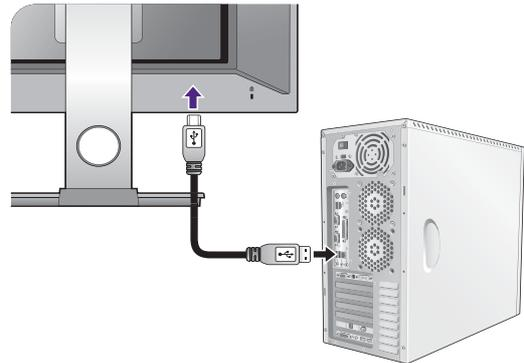
Schließen Sie USB-Geräte über andere USB-Anschlüsse (Downstream) an den Monitor an. Diese Downstream-USB-Anschlüsse übertragen Daten zwischen angeschlossenen USB-Geräten und dem Upstream-Anschluss.
