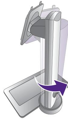
Entfernen Sie anschließend den Sockel vom Ständer.
