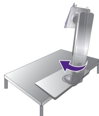
Ziehen Sie die Schraube unten am Monitor wie in der Abbildung gezeigt fest. Drehen Sie Ständer anschließend entgegen dem Uhrzeigersinn, damit er nach vorn zeigt.
