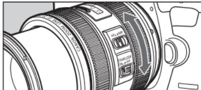
**2** Stellen Sie den Zoomring ein und positionieren Sie die Kamera, indem Sie sie nach vorn oder hinten bewegen. Stellen Sie die Vergrößerung ein und erreichen Sie ein ungefähres Scharfstellen mithilfe des Zoomrings, um den Fokussierabstand einzustellen.
