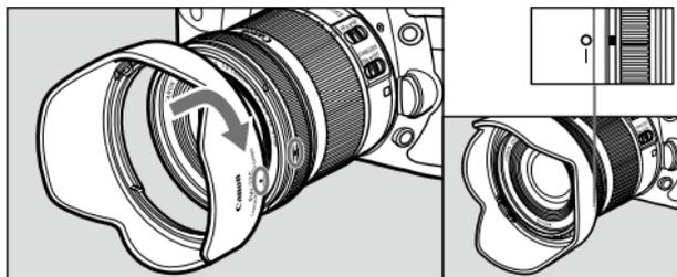
Die Gegenlichtblende EW-73C verhindert unerwünschten Lichteinfall und schützt die Vorderseite des Objektivs vor Regen, Schnee und Staub. Zum Aufsetzen fluchten Sie zunächst die Ansetzmarkierung der Gegenlichtblende mit dem roten Punkt vorn am Objektiv. Drehen Sie dann die Blende in Pfeilrichtung, bis sich der rote Punkt am Objektiv mit der Anschlagmarkierung der Gegenlichtblende deckt. Zur Aufbewahrung lässt sich die Gegenlichtblende umgekehrt auf das Objektiv aufsetzen.
