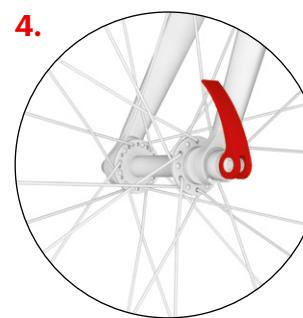
Dokręć nakrętkę regulującą mechanizm szybkiego uwalniania do właściwej pozycji. Gdy znajdziesz się w prawidłowej pozycji poczujesz zauważalny opór tuż przed całkowitym zamknięciem mechanizmu. Zamknij dźwignię zwalniającą w takiej pozycji, aby nie dotykała widelca i aby jednocześnie nie było możliwe przypadkowe otwarcie jej podczas jazdy.
