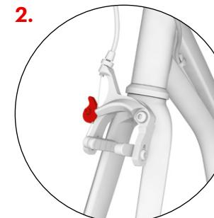
Najpierw sprawdź, czy przedni widelec skutera jest prawidłowo ustawiony (ramiona V-brake powinny być skierowane do przodu w kierunku przedniej części skutera), a następnie zwolnij hamulec poprzez obrócenie dźwigni.
