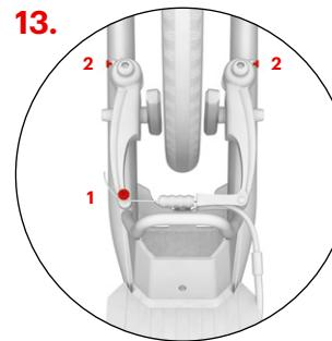
Controllare se quando si rilascia la leva del freno i pattini si allontanano sufficientemente dal cerchione (1-2 mm). La distanza tra i pattini può essere regolata tendendo oppure allentando il cavo del freno sul bullone di ancoraggio (1). Se girando, la ruota tocca i pattini del freno, regolare simmetricamente la distanza dei due braccetti del freno con l'aiuto delle viti di fissaggio (2).
