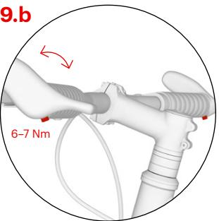
Pour le modèle Yedoo Wolfer, vous pouvez ajuster aussi la position des cornes du cintre à l'aide des vis de fixation.
