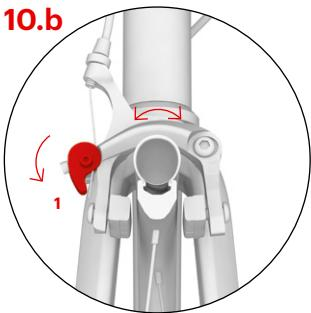
Si la roue en tournant entre en contact avec le patin de frein, tournez légèrement le mécanisme de frein de sorte que les bras de frein soient écartés de la jante d'une distance identique. Les bras seront bloqués dans cette position en tournant le levier vers le bas (1).
