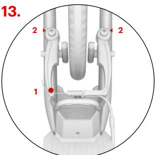
Sprawdź, czy klocki hamulcowe odsuwają się od obręczy w dostatecznym stopniu (1–2 mm), kiedy dźwignia hamulca zostanie zwolniona. Odległość klocków hamulcowych można regulować poprzez dokręcenie lub poluzowanie śruby mocującej linkę hamulca (1). Jeśli klocki hamulcowe wchodzą w kontakt z obręczą w czasie, kiedy koło się obraca, ustaw odstęp ramion hamulców symetrycznie za pomocą śrub regulujących (2).
