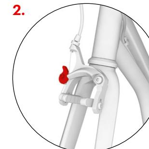
Nejprve zkontrolujte, zda je přední vidlice koloběžky natočen ve správném směru (ramena V-brzdy směřují dopředu), pak uvolněte brzdové čelisti pootočením páčky.
