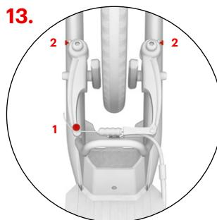
Проверьте, чтобы при отпускании ручки тормоза колодки достаточно отдалились от обода (1–2 мм).
