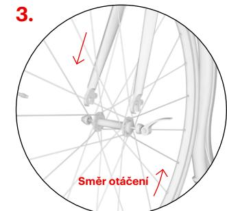
Kolo vsadte do přední vidlice tak, aby bylo přesně uprostřed. **Pozor:** Vzorek pneumatiky by měl směrovat dopředu po směru jízdy, viz směrová šípka na boku pláště.
