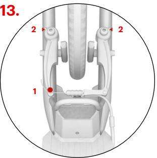
Zkontrolujte, zda se špalíky při uvolnění brzdové páčky dostatečně oddálí od ráfku (1-2 mm). Vzdálenost špalíků lze upravit přítažením či povolením brzdového lanka v kotevním šroubu (1). Pokud kolo při otáčení v některém místě škrťá o brzdový špalík, symetricky upravte vzdálenost brzdových rámenní napínacími šroubkami (2).
