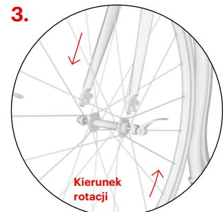
Włóż koło do przedniego widełca tak, aby znajdowało się dokładnie pośrodku. **Uwaga:** Podczas zakładania koła upewnij się, że strzałka na boku opony wskazuje kierunek obrotu koła, gdy hulajnoga toczy się do przodu.
