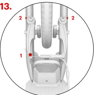
Kontrollige, et piduriklotsid eemalduks pidurihoova vabastamisel veljest piisavalt (1-2 mm). Piduriklotside kaugust saab muuta ankrupoldiga piduritrossi pingutamise või lõvdvendamise teel (1). Kui piduriklotsid puutuvad ratta põõrlemise ajal velje vastu, siis reguleerige pidurivarte kaugust pingutamispoltidega (2) sümmeetriliselt.
