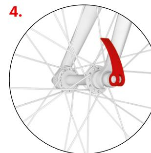
Dotáhněte seřizovací matici rychloupínáku, těsně před dovršením rychloupínací páčky byste měli cítit znatelný odpor. Páčku zavřete v takové pozici, aby se nedotýkala vidlice a zároveň nemohlo dojít k jejímu náhodnému otevření během jízdy.
