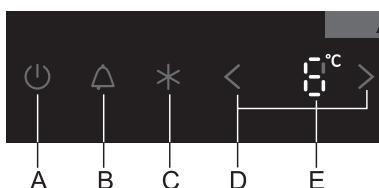
Použite túto funkciu, ak si neželáte manuálne upravovať nastavenia spotrebiča. Funkciu aktivujete stlačením a podržaním tlačidla **B** (tri sekundy); na displeji **E** sa objaví **LL**.
