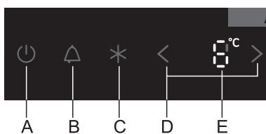
Zapnutie spotrebiča: Spotrebič zapnite krátkym stlačením tlačidla **A**.
