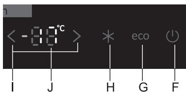
**Vypnutie spotrebiča:** Spotrebič vypnete stlačením a podržaním (tri sekundy) tlačidla **F** (výstraha: spotrebič zostáva napájaný, t. j. stále je v ňom elektrický prúd).
