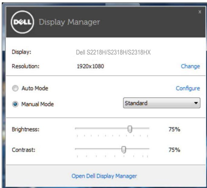
Dialógové okno **Quick Settings (Rýchle nastavenia)** umožňuje aj prístup k rozšírenému používateľskému rozhraniu Dell Display Manager, ktoré slúži na nastavenie základných funkcií, konfiguráciu automatického režimu a vstupovanie do ďalších funkcií.
