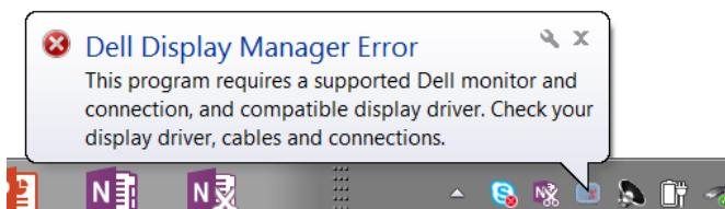
Upozorňujeme, že DDM pracuje iba s monitormi značky Dell. Ak používate monitory od iných výrobcov, DDM ich nepodporuje.
