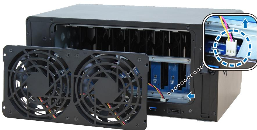
**c** Vyšroubujte 4 šrouby zajišťující nefunkční ventilátor a poté ventilátor vyndejte.
