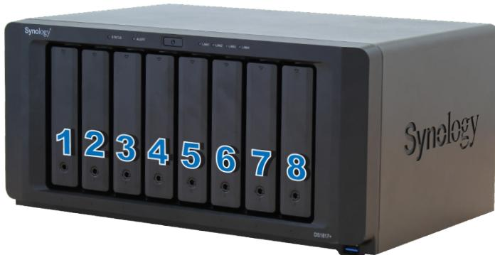
**Poznámka:** Pokud chcete nastavit svazek RAID, doporučujeme vám, aby z důvodu co nejlepšího využití kapacity disků měly všechny nainstalované disky stejnou velikost.
