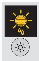
Po provedení volby programu vybaveného volitelnou funkcí Automatické sušení víckrát po sobě stiskněte tlačítko, dokud nebude zobrazena požadovaná úroveň automatického sušení. Když volitelná funkce automatického sušení není k dispozici, displej bude blikat a budou vydány tři akustické signály.
