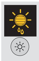
Depois de ter seleccionado um programa com a opção Secagem automática, prima várias vezes o botão até visualizar o nível de secagem automática pretendido. Se a opção de secagem automática não estiver disponível, o visor fica intermitente e são emitidos três sinais acústicos.
