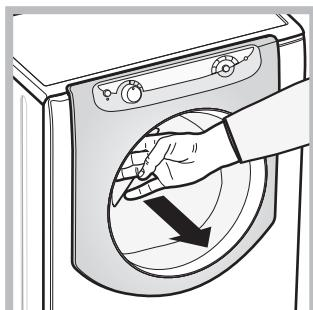
K otevření dvírek s průzorem používejte vždy příslušné madlo (viz obrázek).
