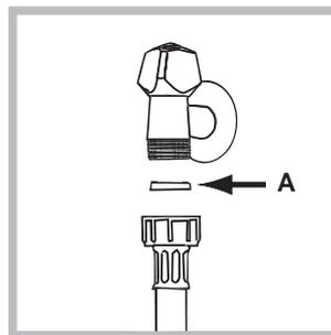
1. Die Gummidichtung in das Anschlussstück des Zulaufschlauches einlegen und an einen 3/4" Kaltwasserhahn dicht anschliessen (siehe Abb.). Lassen Sie das Wasser vor dem Anschluss so lange auslaufen, bis klares Wasser austritt.
