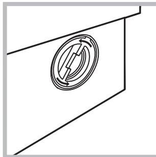
1. dévisser le couvercle en le tournant dans le sens inverse des aiguilles d'une montre (voir figure); il est normal qu'un peu d'eau s'écoule;
