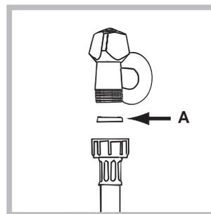
1. Monter le joint A sur l'extrémité du tuyau d'alimentation et le visser à un robinet d'eau froide à embout fileté 3/4 gaz (voir figure). Faire couler l'eau jusqu'à ce qu'elle soit limpide et sans impuretés avant de raccorder.
