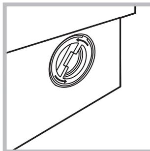
1. Drehen Sie den Deckel gegen den Uhrzeigersinn ab (siehe *Abbildung*); es ist ganz normal, wenn etwas Wasser austritt;
