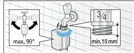
**Upozornění:** Opatrně otvírejte přívod vody a kontrolujte těsnost spojů. Šroubový spoj je pod vodovodním tlakem.
