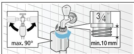
**Upozornenie:** Opatrne otvárajte prívod vody a kontrolujte tesnosť spojov. Skrutkový spoj je pod vodovodným tlakom.
