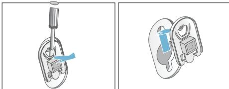
2. Vložte všetky štyri objímky. Uppnite kábel bezpečne do držiakov. Vložte a upevnite skrutky.
