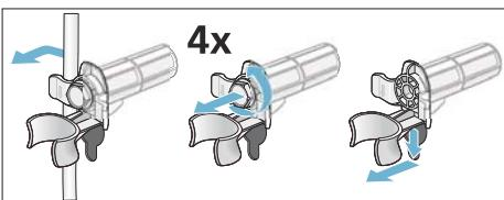
3. Nasadte kryty. Upevněte kryty na místě zatlačením na příchytky.
