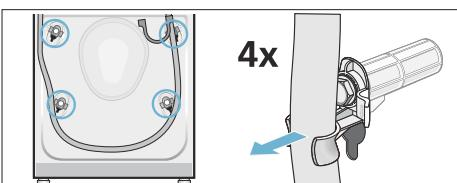
2. Uvolněte kabel z držáků. Odšroubujte a odstraňte všechny čtyři šrouby přepravních pojistek. Odstraňte objímky.
