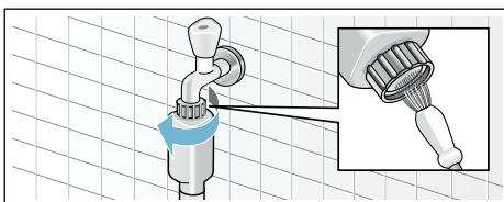
6. U modelů standardních a Aqua-Secure vyčistěte sítno na zadní straně spotřebiče: Odstraňte hadici ze zadní části spotřebiče. Vyjměte sítno kleštěmi, a pak ho vyčistěte.
