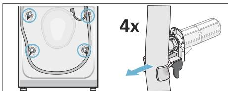
2. Uvoľnite kábel z držiakov. Odskrutkujte a odstráňte všetky štyri skrutky prepravnnej poistiky. Odstráňte objímky.
