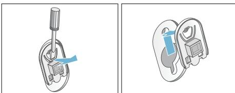
2. Vložte všechny čtyři objímky. Upněte kabel bezpečně do držáků. Vložte a upevněte šrouby.
