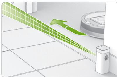
**Modalità Virtual Wall:** Quando l'interruttore si trova in posizione "su" (☒), il dispositivo funge da muro virtuale. Ciò significa che è possibile impostarlo per bloccare le aperture fino a 3 metri. Si crea una barriera invisibile conica che solo Roomba può vedere.
