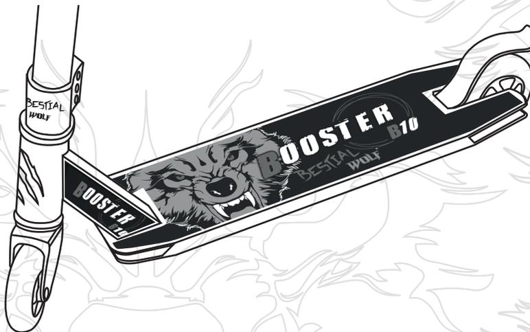
Al girar el manillar de izquierda a derecha este debe realizar las maniobras suavemente de no ser así o si comprueba que existe un excesivo juego en la parte del mecanismo, ruidos extraños o cualquier otra anomalía, deberá realizar la sustitución del sistema de dirección, para ello póngase en contacto con su distribuidor.
