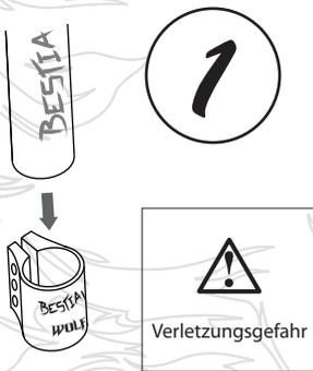
1 y 2) Schieben sie den Bar in die Clamp und stecken sie den Bar auf die Fork
