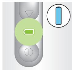
Când bateriile sunt complet încărcate, LED-ul de încărcare luminează verde continuu. Bateriile complet încărcate furnizează cel puțin 370 de pulsații la nivelul 5 de intensitate a luminii.
