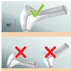
**2** Zařízení přitiskněte kolmo k pokožce tak, aby nástavec a bezpečnostní kroužek byly v kontaktu s vaší pokožkou. Bezpečnostní kroužek zabraňuje neúmyslným zábleskům bez kontaktu s pokožkou.
