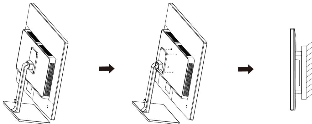
Tento monitor lze připevnit na závěsné rameno, které lze zakoupit samostatně. Než budete pokračovat v montáži, odpojte napájení. Postupujte takto:
