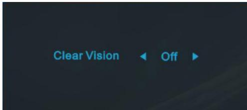
3. Stisknutím a podržením tlačítka „<“ po dobu 5 sekund aktivujte Demo čistého zobrazení a na displeji se po dobu 5 sekund zobrazí zpráva „Clear Vision Demo: on“ (Demo čistého zobrazení: zapnuto). Stisknutím tlačítka Nabídka nebo Konec zpráva zmizí. Dalším stisknutím a podržením tlačítka „<“ po dobu 5 sekund se funkce Clear Vision Demo (Demo čistého zobrazení) vypne.
